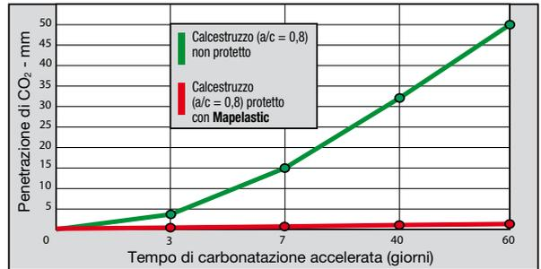
Fig. 2: Effetto di Mapelastic sulla carbonatazione accelerata (30% di CO<sub>2</sub>) in un calcestruzzo poroso
