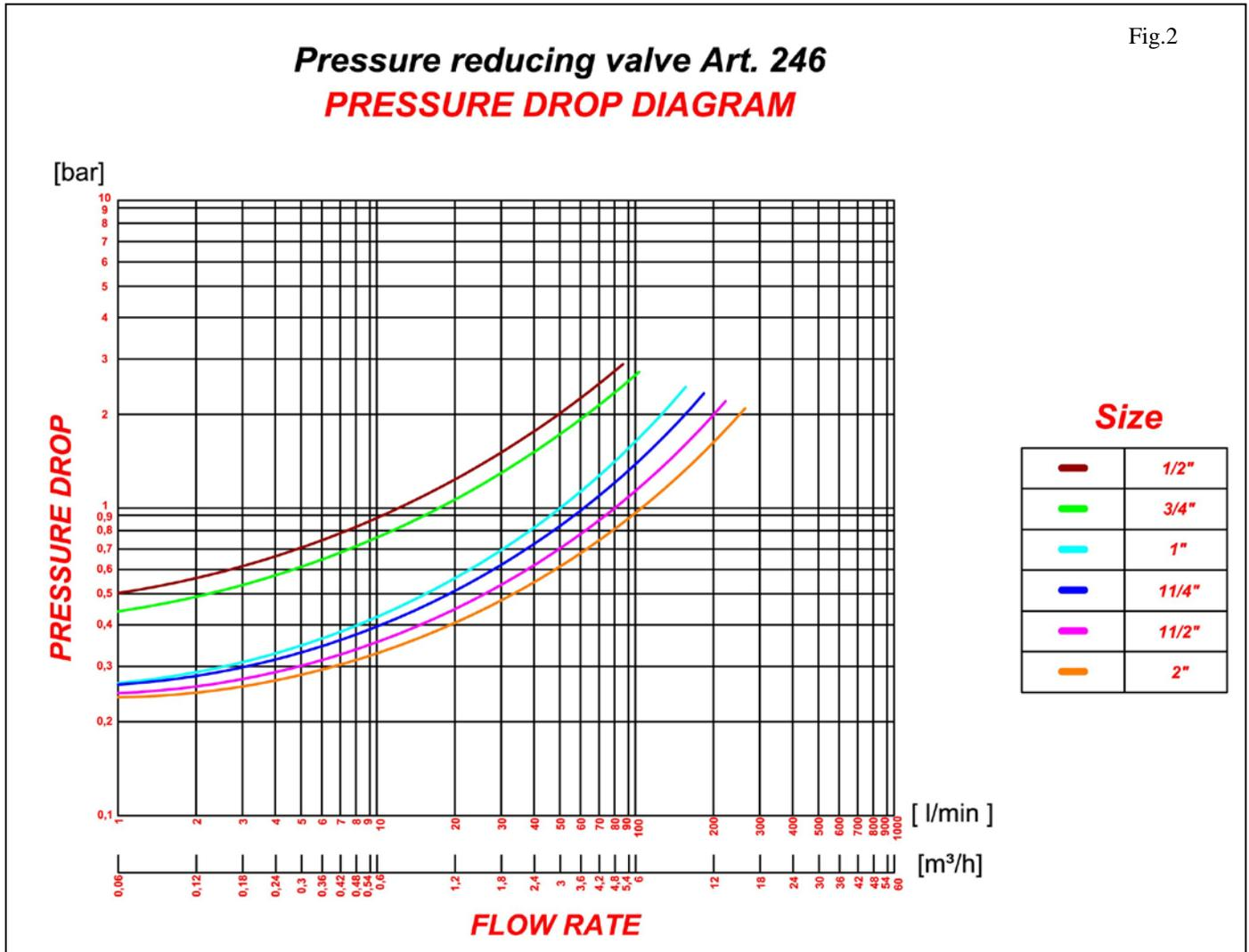
Il diagramma delle perdite di carico del riduttore, rappresenta la perdita di pressione in funzione della portata all'uscita delle utenze.
