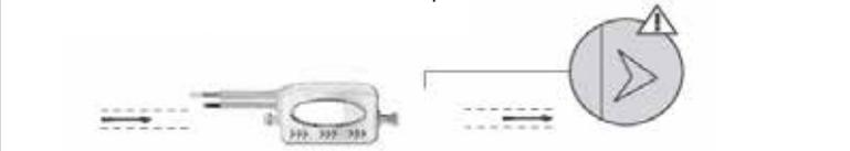
6. Inserire il tubo con un diametro interno di 6 mm sul serbatoio e sulla pompa. Fissare con fascette ed assicurarsi che la lunghezza sia inferiore ai 2 metri.
