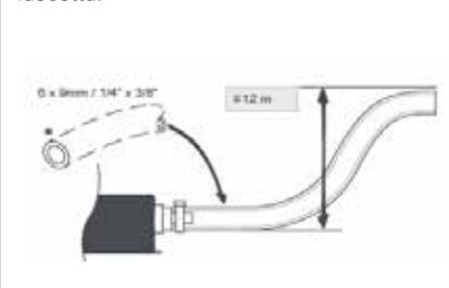
8. Incanalare il tubo di scarico verso un drenaggio adeguato, evitando restrizioni.
