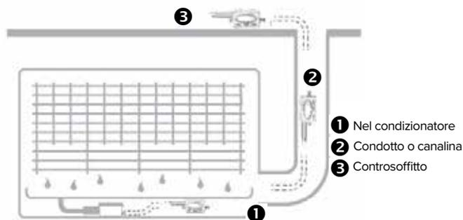
Nel caso in cui l'uscita del tubo di mandata della pompa si trovi ad un livello più basso rispetto al blocco della pompa ed al fine di prevenire un effetto sifonante (scarico negativo), è necessario adottare una delle seguenti misure:
