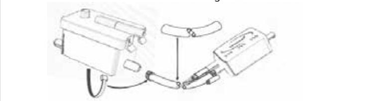
7. Collegare il tubo di all'uscita del raccordo sulla MDF e fissarlo con una fascetta.
