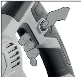
•Per avviare la macchina, premere l'interruttore On/Off e tenerlo premuto. Per bloccare l'interruttore di accensione/spengimento, premere il pulsante di blocco.
