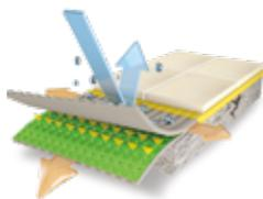
**1. È una membrana tricomposta:** Green-Pro è il risultato di un percorso di progettazione innovativa finalizzata all'ottimizzazione delle superfici di contatto: un sistema superficiale d'armatura tridimensionale composto da fibre polimeriche e uno speciale tessuto TNT garantiscono adesioni strutturali con il gel-adesivo H40® No Limits® nella posa della membrana e nell'incollaggio del rivestimento.
