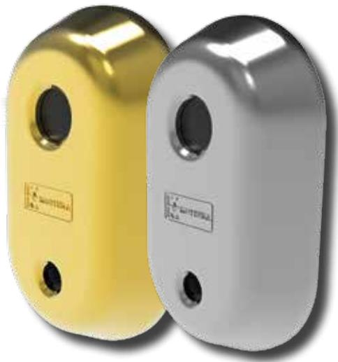
Il **Defender® DF301 (Brev.) magnetico**, è composto da un monoblocco in Zama (70 x 120 mm) con al suo interno un **Defender®** in acciaio, disponibile di base per spessori pannello da 5 mm. **Massimo livello di sicurezza con protezione entrata chiave in manganese apribile solo con l'apposita chiave magnetica.**
