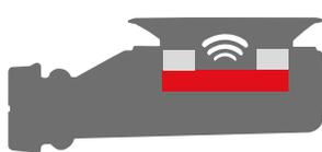
Una volta terminata la doccia il flusso diminuisce, la forza magnetica fa chiudere il piattello che si posiziona nella sua sede riempiendosi di acqua. Il battente d'acqua, che funge da seconda sifonatura, è pari a 1 cm.
