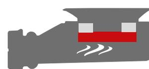
La forza magnetica mantiene ermeticamente chiuso il piattello. Il sistema di sifonatura magnetica unito al battente d'acqua assicura una tenuta totale e impedisce il reflusso di cattivi odori e lo svuotamento dei sifoni.
