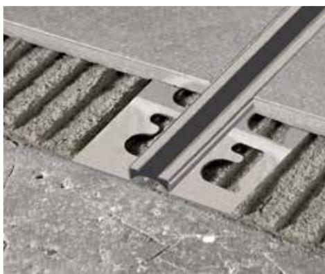
Non utilizzare **PROFLEX ACC** in acciaio inox AISI 304 / 1.4301 – V2A in piscina e in ambienti ove siano presenti sostanze molto aggressive. Per il taglio del profilo si raccomanda l'uso di un seghetto a mano con lama in acciaio e di trattare le superfici tagliate con paste passivanti per acciaio.
