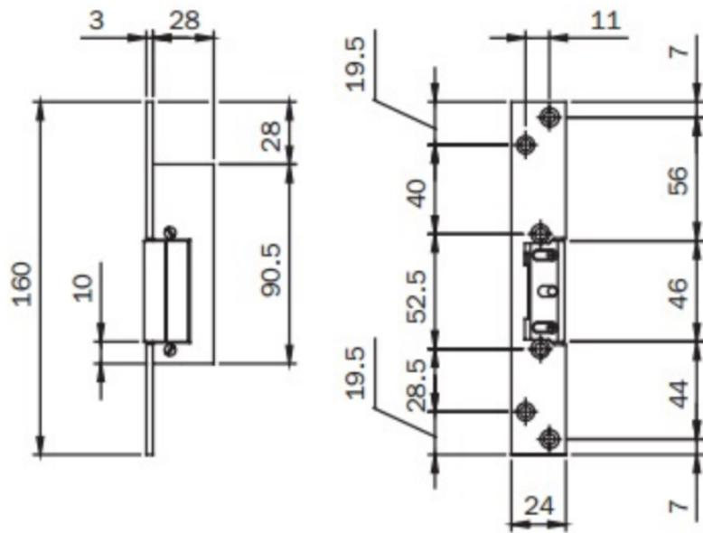
Incontro elettrico con frontale piatto acciaio INOX mm **160x24x3**, UTILIZZABILE DESTRO O SINISTRO, per serrature da infilare per serramenti in alluminio, apertura con **SGANCIAMENTO PERMANENTE DOPO L'IMPULSO ELETTRICO**, con leva fermo a giorno, perno di presenza scrocco. Voltaggio: **12Vac 15W.**
