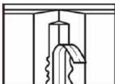
2. Applicare la banda in rete PregyAquaBoard centrandola sull'asse del giunto
