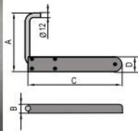
Ferma persiana universale, in ABS, braccio estensibile, con molla in acciaio inox, viti di fissaggio e tappi copriforo.
