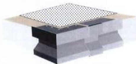
SUCCESSIVAMENTE APPORRE NASTRO ADESIVO SUL BORDO RICOPRENDO LE ASOLE DI DRENAGGIO PER NON TAPPARLE.
