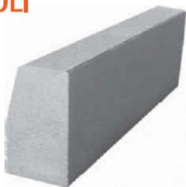
Cordolo per la costruzione di cigli di marciapiede, delimitazione di percorsi stradali, margini di rotonde, arredo urbano, ecc., con bordo smussato nello spigolo a vista. Gli elementi (pieni o alleggeriti) possono essere prefabbricati in conglomerato cementizio vibrocompresso oppure in calcestruzzo bianco a getto, con resistenza caratteristica cubica ( $R_{ck}$ ) non inferiore a 25 MPa (250 kg/cm<sup>2</sup>). Le geometrie possono essere rettilinee o curve (curva a 90°).
