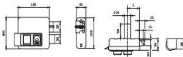
Elettroserratura da applicare **DESTRA VERNICIATA. 12Vac 15W**. Pulsante intero. 2 mandate azionabili con cilindro interno e cilindro fisso  $\varnothing$  mm 26x50 esterno. Scrocco autobloccante con pistone di carica incorporato forza regolabile. 3 CHIAVI. Bocchetta regolabile. Ghiera. Foglio istruzioni.
