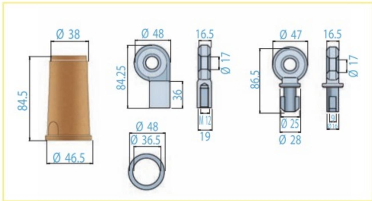
**Gruppo composto da una campana in ottone con ghiera di guarnizione e una coppia di occhioli in acciaio. Da impiegare con lucchetti corazzati da 90 mm.**
