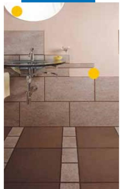
*Esempio di piastrelle in gres porcellanato in un bagno stuccate a parete e a pavimento con Ultracolor Plus*
