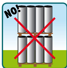
Evitare di sovrapporre i bancali senza adeguato ripartitore di carico.
