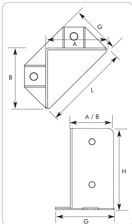
La coppia di supporti di ancoraggio Unifix - SWG è costituita da 2 componenti sottoposti a zincatura a caldo. Il piede d'appoggio consente di giuntare montanti in legno con elementi strutturali massicci, quali fondazioni o pavimenti. La trave da sostenere può avere dimensioni variabili. Il lato della trave deve tuttavia corrispondere in lunghezza almeno al fianco della sezione superiore.
