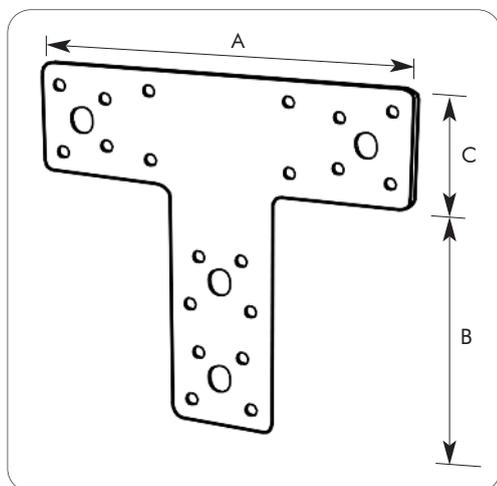
I supporti per travi a T Unifix – SWG vengono realizzate in lamiera d'acciaio con spessore di 2,0 o 2,5 mm. Il numero dei fori varia in funzione delle dimensioni.
