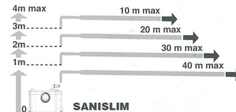
Prevedere una pendenza dell'1% per i tubi di scarico posti orizzontalmente.
