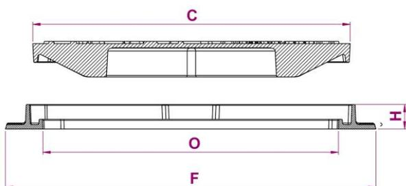
**DESCRIZIONE** Dispositivo di chiusura in ghisa sferoidale GJS 500-7 secondo la norma EN 1563, conforme alla norma EN124-2:2015 in particolare conforme alla classe di portata C250, carico di rottura >250 kN ( $\geq t 25$ ), recante il marchio di certificazione di prodotto IGQ (Istituto Italiano di Garanzia della Qualità) ed il marchio di conformità UNI.
