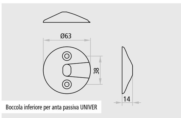
Boccola inferiore per anta passiva UNIVER
