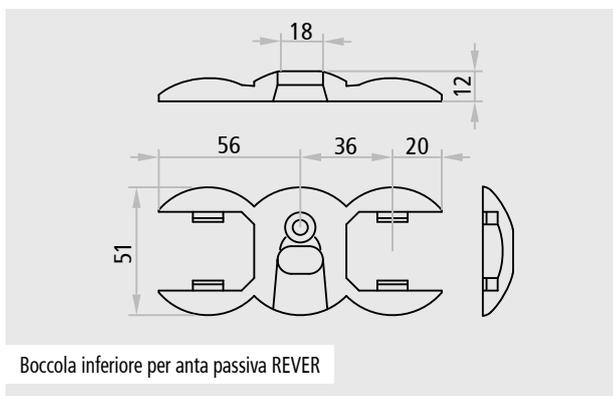
Boccola inferiore per anta passiva REVER
