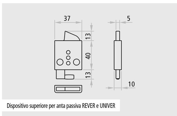
Dispositivo superiore per anta passiva REVER e UNIVER
