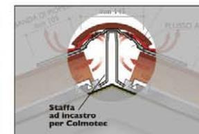
4) Fissare l'elemento di colmo al **colmotec**<sup>®</sup> utilizzando gli appositi ganci fermacolmo.
