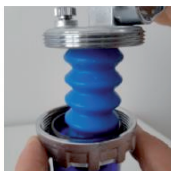
riavvitare il vasetto, chiudere la valvola di sfiato e la valvola by pass.
