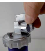
riavvitare il vasetto, chiudere la valvola di sfiato e la valvola by pass.
