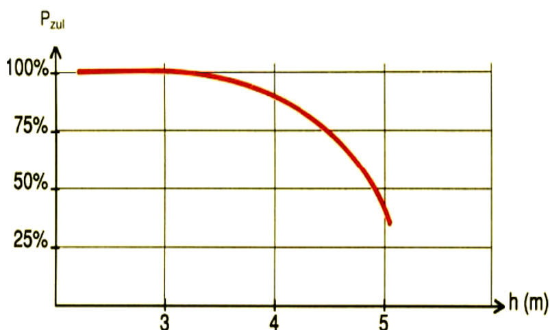
Andamento del carico ammissibile in % in funzione della lunghezza di estensione del puntello. (Immagine tratta da: Suva - sicurezza sul lavoro)
